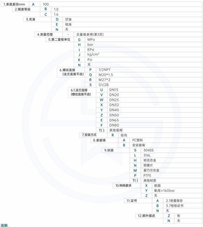
表示A45型压力表表盘直径为100mm,精度等级为1.0%,耐震充硅油,量程范围为:0~0.6MPα,无第二量程单位,过程连接1/2NPT(6.6.1为 二选一), 径向安装, 安全玻璃, 本体材质为304SS, 上述表格中第11/12/13项部分为非必选项。
