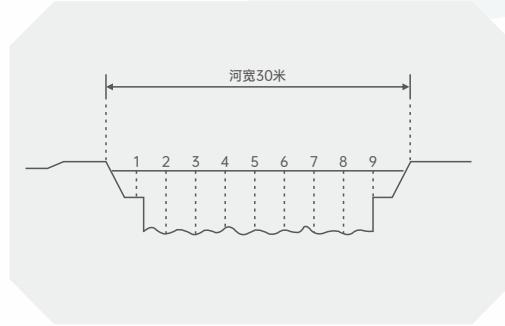
在河道的两岸和中间各装一个传感器，然后全部接到同一个主机上
