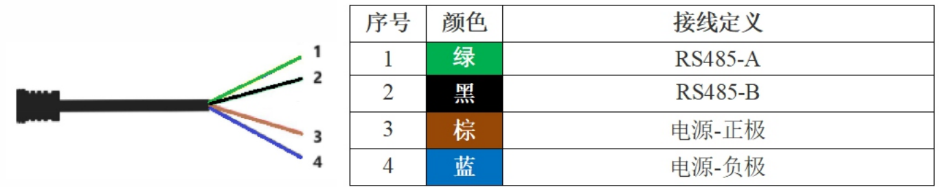
输出RS485产品接线示意图
