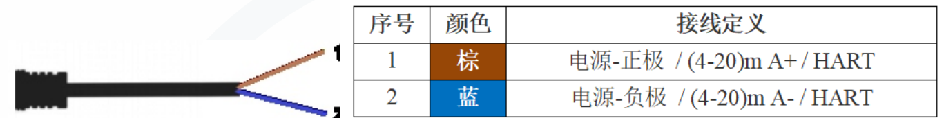
输出(4-20)mA产品接线示意图
