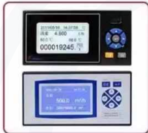
128*64点阵单色液晶 显示器 (LCD)
